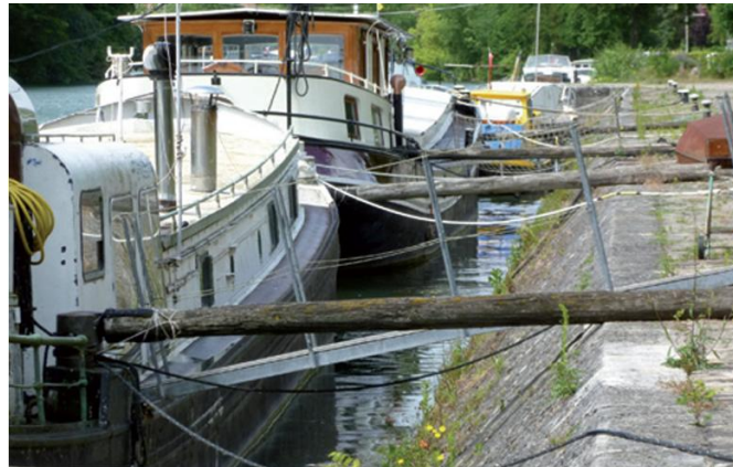
Ecoire : Tubes rigides à l'amont et à l'aval de l'embarcation permettant de la maintenir à distance du quai
