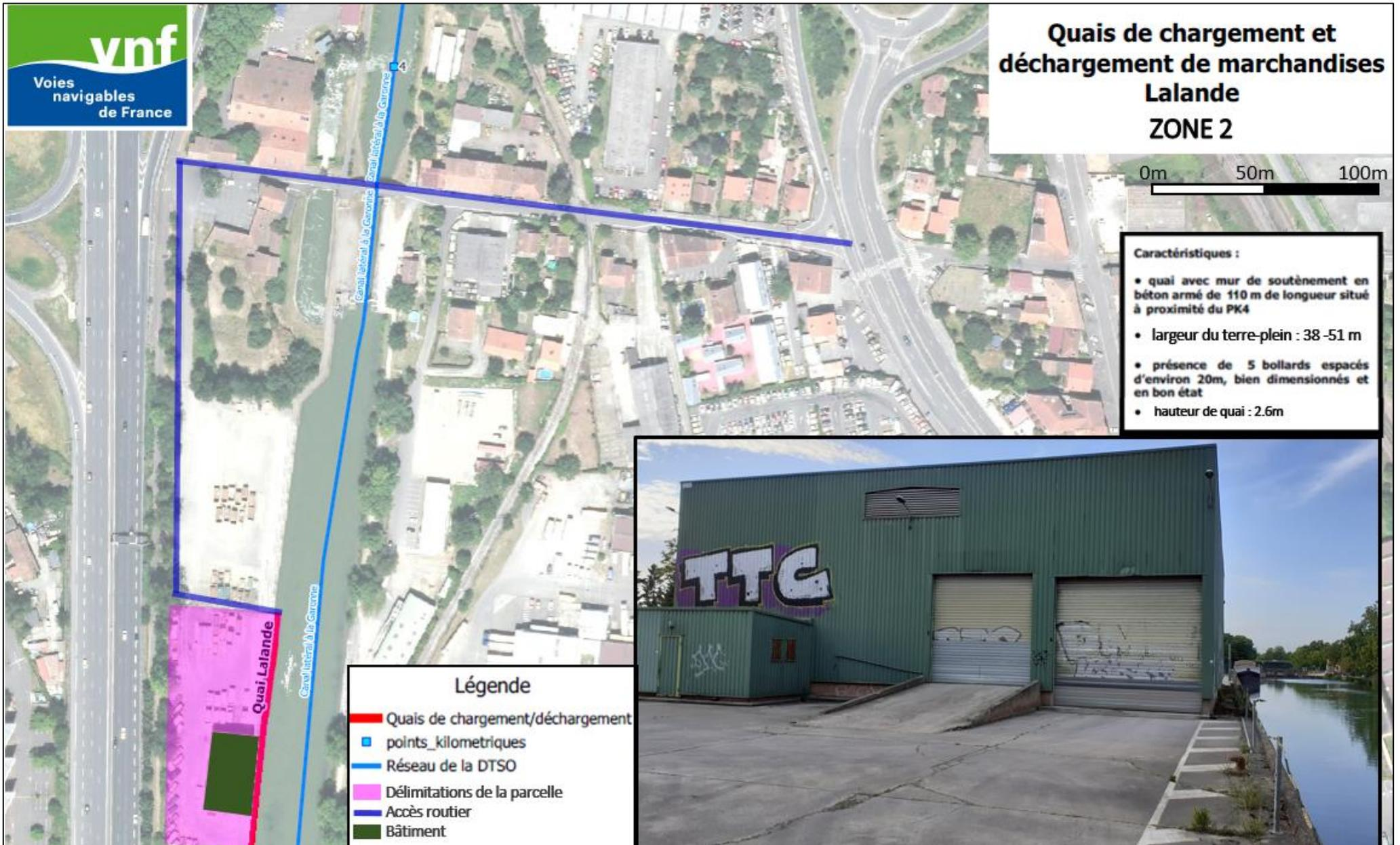
Figure 14 : Détail du quai de chargement/déchargement de Lalande - zone 2..
