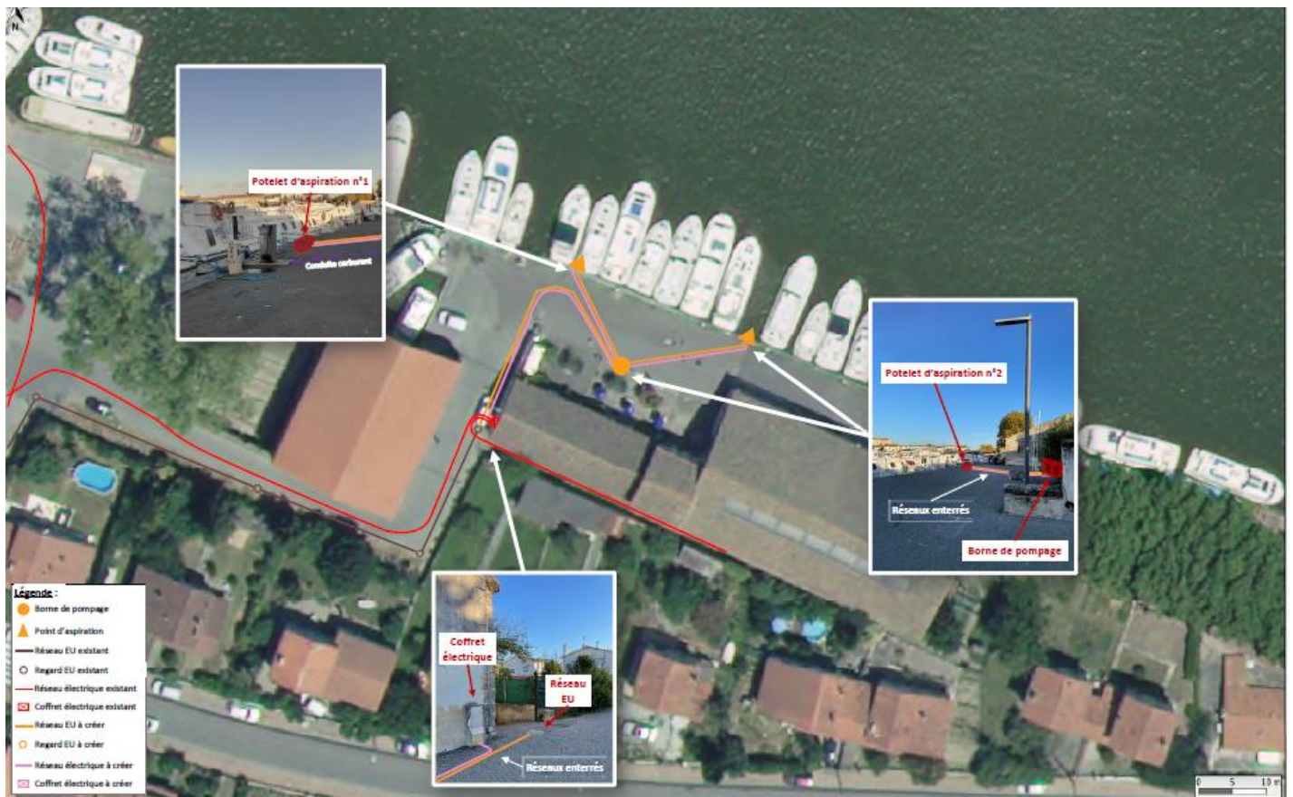
Figure 13 : Implantation de la station de dépotage - Port de Castelnaudary
